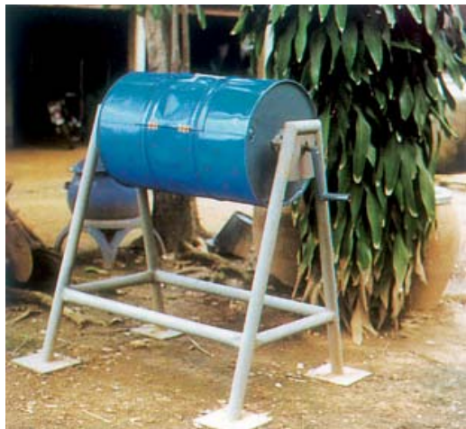
รูปที่ 8 ถังหมักมูลฝอยจำพวก เศษใบไม้ หญ้า เปลือกผลไม้ เป็นการหมักมูลฝอยแบบแห้ง
