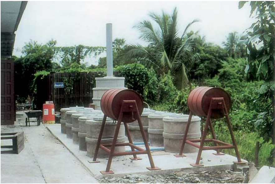
รูปที่ 13 ถังหมักปุ๋ยน้ำชีวภาพ ถังหมักปุ๋ยอินทรีย์ และเตาเผามูลฝอย
