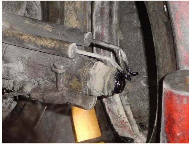
รูปที่ 6-46 คราบน้ำมันที่จับตัวบนหัวฉีดและเขี้ยวสปาร์ค
