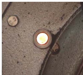
รูปที่ 6-45 กระจกดูไฟหน้าเตา
