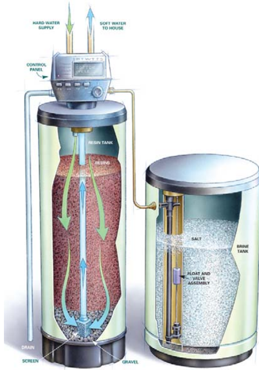
รูปที่ 5-3 ขั้นตอนการกรองน้ำเพื่อผลิตน้ำอ่อน
