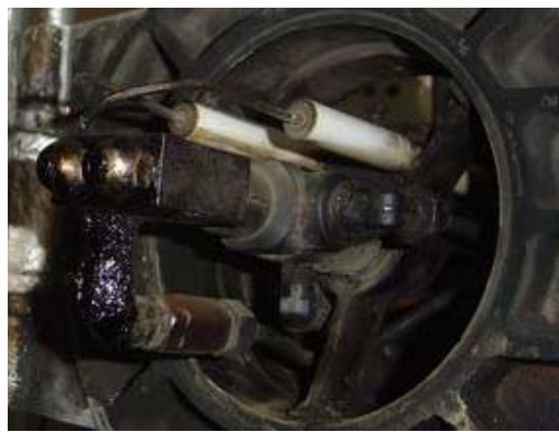
รูปที่ 6-32 หัวฉีด 2 หัวในหัวเผาแบบพ่นฝอยโดยใช้แรงดันน้ำมัน ควบคุมแบบไฟมาก-น้อย
