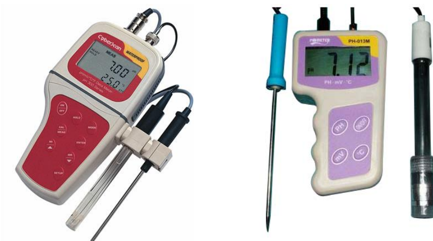
รูปที่ 5-14 เครื่องวัดค่าพีเอชแบบดิจิตอล
