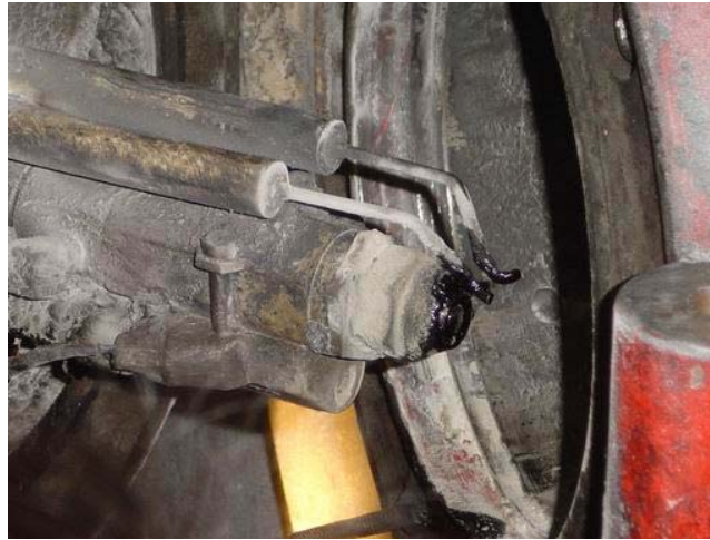
รูปที่ 6-46 คราบน้ำมันที่จับตัวบนหัวฉีดและเขี้ยวสปาร์ค
