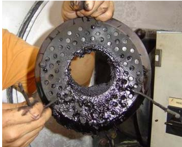
รูปที่ 6-47 คราบน้ำมันบนกระจิงลม
