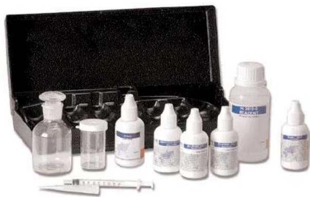
รูปที่ 6-16 เครื่องวัดปริมาณอากาศส่วนเกินจากปริมาณออกซิเจนแบบน้ำยาเคมี
