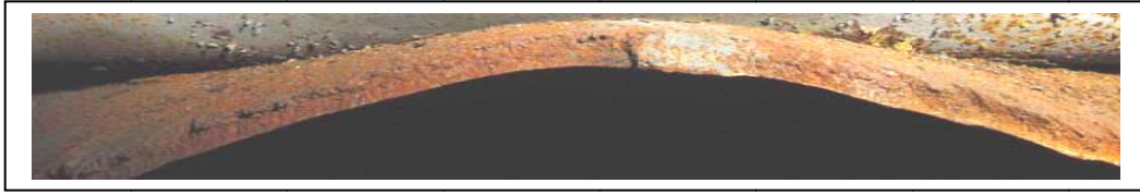
รูปที่ 6.14 ความหนาของผิวแตกไม่มีการลดลง
