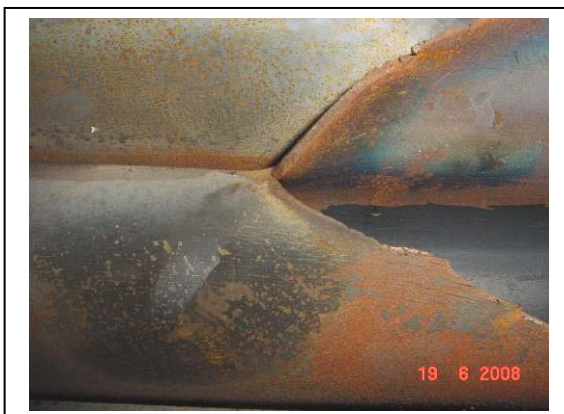
รูปที่ 6.13 รอยแตกของท่อมีลักษณะเป็นรูป “ปากปลา” และมีรอยร้าวเล็กที่ขอบผิวแตก
