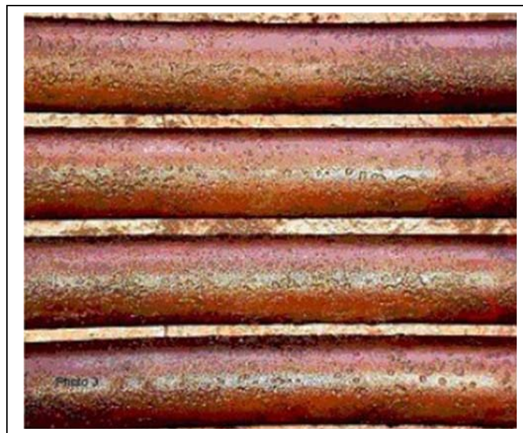
รูปที่ 6.4 แสดงการสูญเสียเนื้อโลหะและการเกิดหลุมบนผิว ของท่อเมื่อพบกับความชื้น และเกิดคราบสนิม
