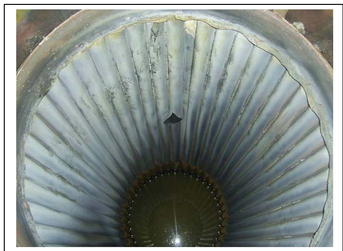
รูปที่ 6.12 หม้อน้ำความดันสูงระเบิด
