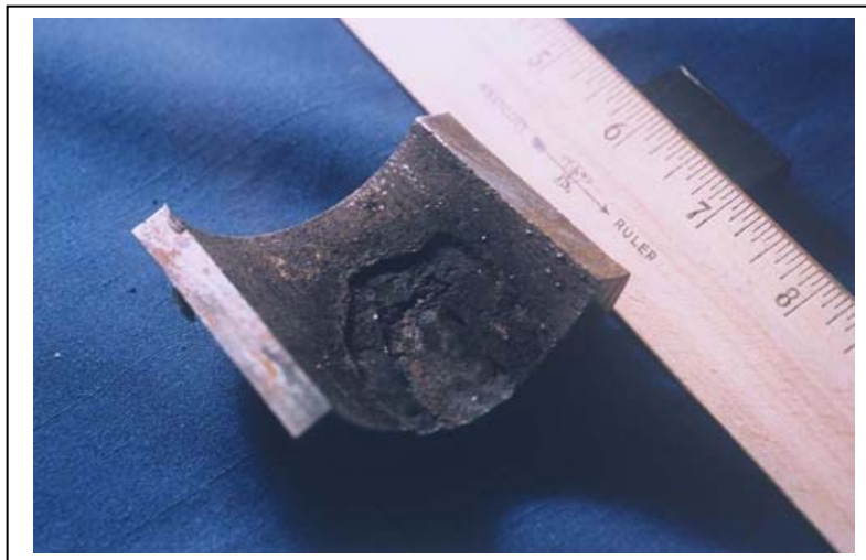
รูปที่ 6.7 แสดง Localized Tube Wall Loss Caused by Caustic Gouging
