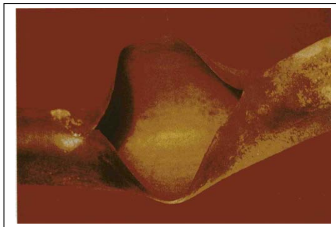
รูปที่ 6.4 การแตกแบบปากปลา (Fish mount)
