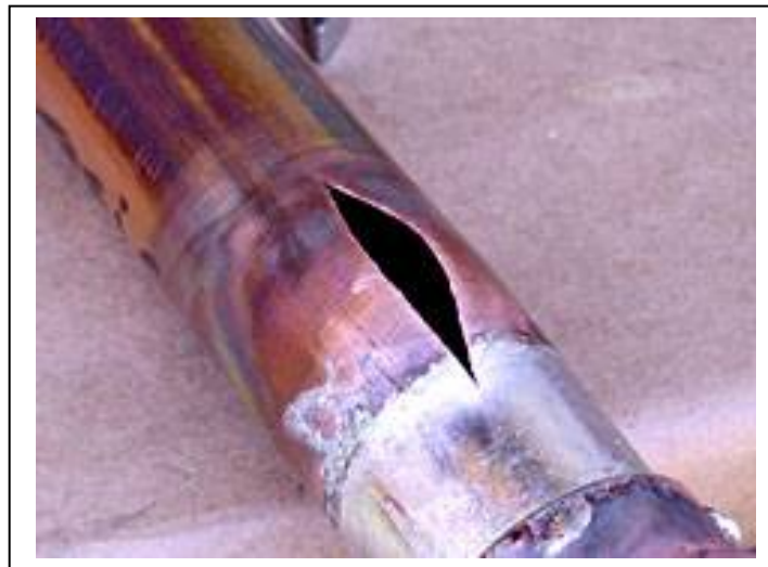
รูปที่ 6.3 แสดงความเสียหายรูป Fish Mouth
