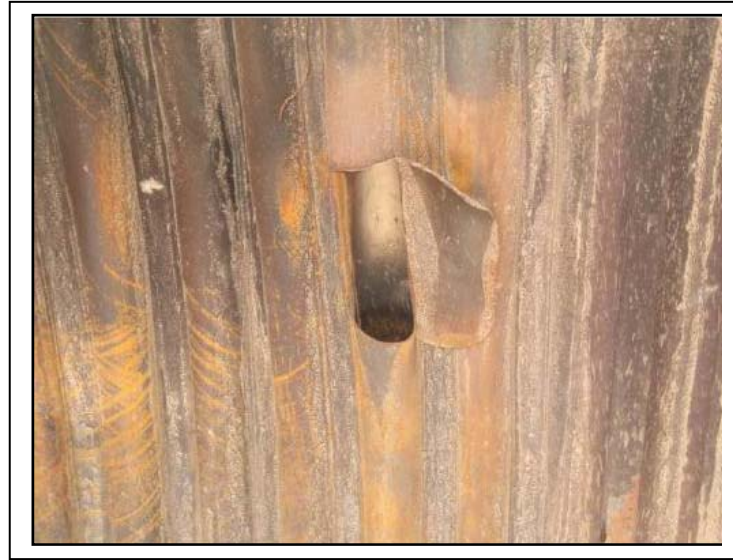
รูปที่ 6.5 การแตกแบบหน้าต่างเปิด(Open window)
