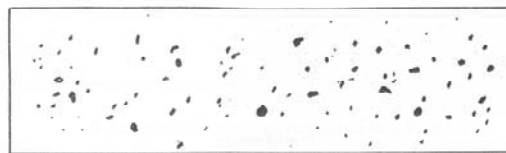
รอยบ่งชี้กระจาย ปริมาณและขนาดที่อนุญาตไว้ที่ความยาวงานเชื่อม 6 นิ้ว ใดๆ
