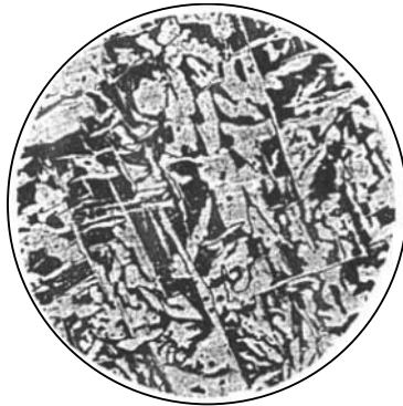
รูปที่ 2.2.6 ลักษณะโครงสร้างของ Widmanstätten คือเฟอไรต์ไลท์ยื่นเข้าไปในเฟอไรต์ไรท์ หรือเฟอไรต์ไรท์ยื่นเข้าไปในเฟอไรต์ไลท์
